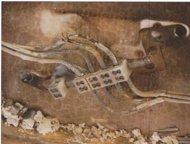
Foto 2: Probekörper „WKE 54“ nach der Durchführung der Brandprüfung gemäß DIN EN 12101-3: 2002
